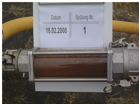
Rohrnetzspülung: Schauglas zur Fotodokumentation der Spülung
